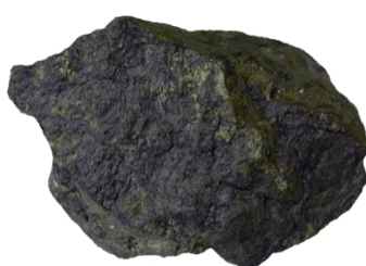
24711 Злато-съдържащо орудяване от енаргит, тенантит, лузонит-фаматинитовата сер. минерали, пирит, халкопирит, рудник „Челопеч“, блок 146, хор. 110, камера 1А
