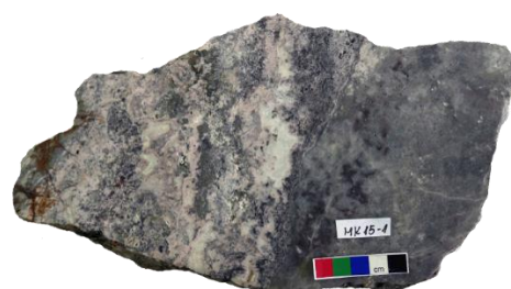
24703 Контакт на рудна жила с карбонатно-полиметално орудяване и кварцова зона, нах. „Милин камък“, основна рудна жила 1, хор. 760-изток, 330 м
