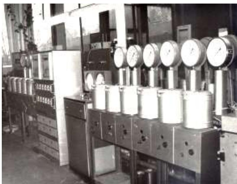
**Рис. 1.** Гидротермальная установка высокого давления с внешним нагревом и холодным затвором (УВД-10000) (Т до ~800-850°C, Р до ~400-520 МПа).
